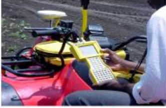
(٢) تركيب جهاز القيادة الأوتوماتيكية من شركة Beeline على الجرار
